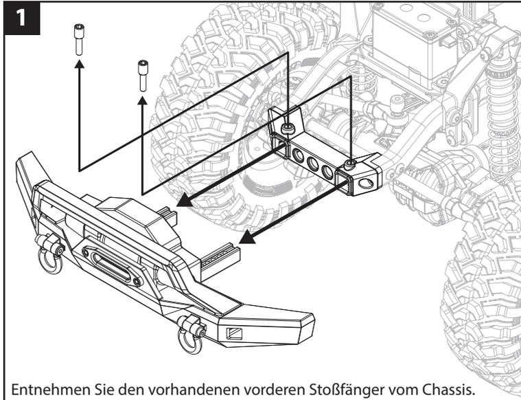
Ihr neuer vorderer Stoßfänger ist für den Einsatz mit der 8088 LED-Lichtleiste (separat erhältlich) ausgelegt. Installieren Sie ihn wie unten abgebildet am Stoßfänger. *Das 8028 LED-Beleuchtungsmodul (auch optional erhältlich) ist erforderlich, um die Lichtleiste mit Strom zu versorgen.*
