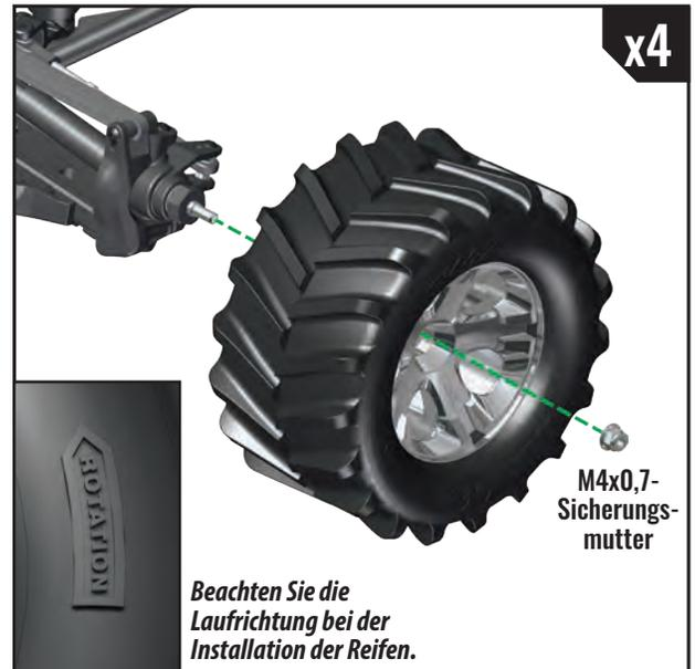
*Beachten Sie die Laufrichtung bei der Installation der Reifen.*
