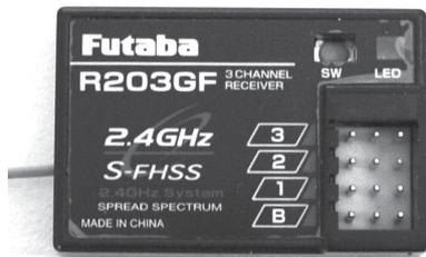
Keine Quarze, keine Frequenzkanalwahl und höchste Sicherheit vor Störungen und Elektrosmog durch 2,4 GHz FHSS Technologie. Bestmögliche Unterdrückung von Störsignalen durch schnelles Frequenz Hopping.
