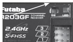
Durch Drücken der Taste "SW" wird im Empfänger automatisch die individuelle Codenummer des Senders (130 Millionen Codes) gespeichert. Durch diese "Bindung" reagiert der Empfänger nur noch auf die Signale des angebindenen Senders.
