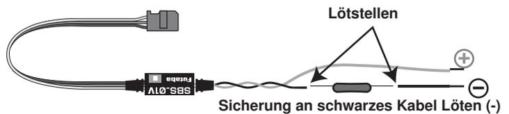
3. Schieben Sie den Schrumpfschlauch über die Sicherung. Achten Sie darauf, dass die Lötstellen abgedeckt werden. Zum Verschrumpfen nutzen Sie einen Heißluftfön.
