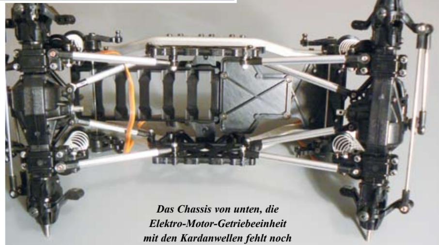
Das Chassis von unten, die Elektro-Motor-Getriebeeinheit mit den Kardanwellen fehlt noch
