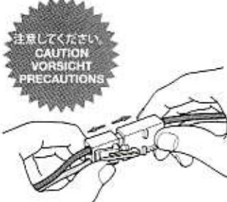
走行させない時は必ず走行用バッテリーのコネクターをはずしてください。走行用バッテリーをつないだままでおくと、車が暴走することがあります。走らせないときは、必ず走行用バッテリーのコネクターを抜いておきます。
