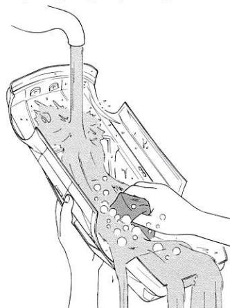
★塗装前に中性洗剤で油気をとします。水洗いし、洗剤分を洗い流して乾かしてください。
