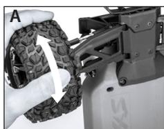
Drehen Sie die Hinterräder langsam, während Sie die Zähne der Ausgangswelle in Position bringen.
