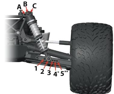
\* Die Stoßdämpferabdeckungen müssen bei den vorderen Armen entfernt werden, um Position 4 zu erreichen.
